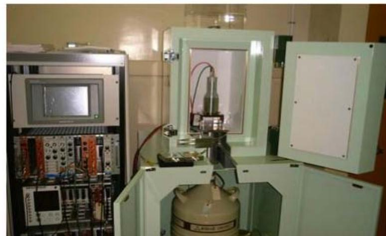
産総研の高純度ゲルマニウム半導体検出器とその計測システム
